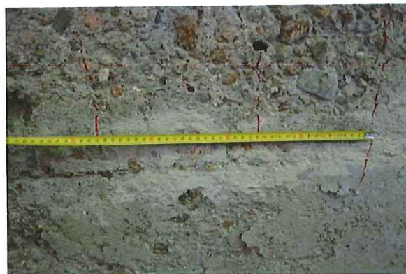
Foto 7.8 Profometrická kontrola polohy výztuže v mostkovkové desce (výztuž hladká Ø 12 mm cca po 200 mm)
