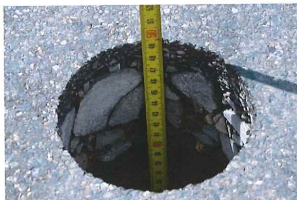
Foto 4.2.2 Detail měření celkové hloubky provedené sondy do skladby vozovky v předpolí s označením SV2
