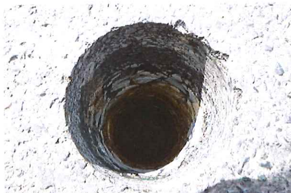
Foto 4.3.3 Detail jednotlivých vrstev viditelných na ostění po vyjmutí fragmentů jádrového vrtu
