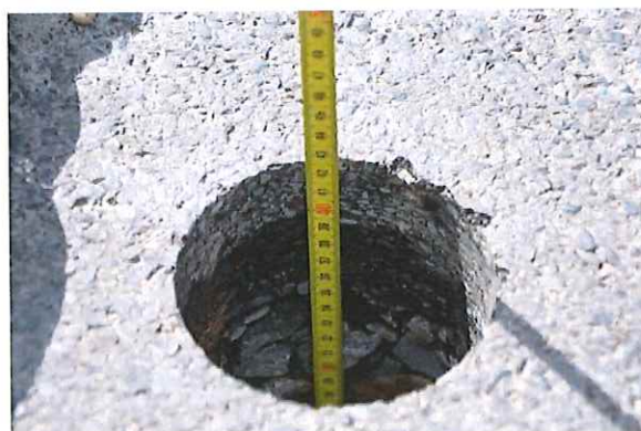
Foto 4.3.2 Detail měření celkové hloubky provedené sondy do skladby vozovky v předpolí s označením SV3
