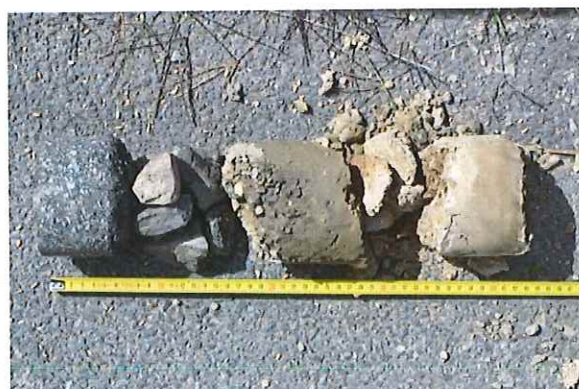
Foto 4.3.4 Skladba vozovky pohled na vyjmuté jednotlivé části z provedené sondy s označením SV3
