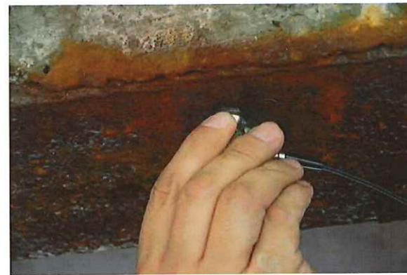
Foto 6.6 Měření tloušťky na obroušeném povrchu povrchově zkorodovaného I nosníku
