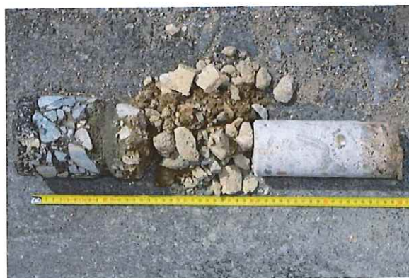
Foto 4.2.4 Skladba vozovky, detail jednotlivých vyjmutých částí skladby s přiloženým metrem
